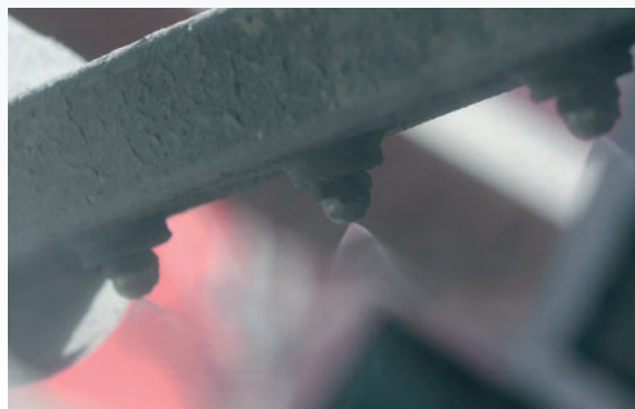
Niederdruck-Nebeldüsen an einer Bandübergabe
