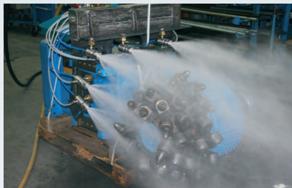
Interner Sprühtest zur Konfiguration der Bedüsung
